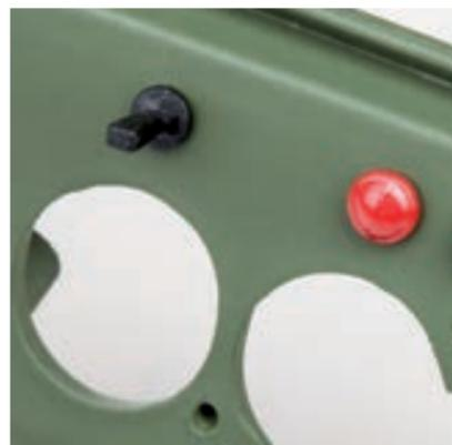
**Шаг 5.** Установите выключатели фары-искателя и щиткового фонаря в свободных отверстиях в центре верхней части панели приборов — над первым и четвертым стрелочными указателями.
