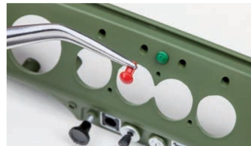
**Шаг 4.** По обеим сторонам от контрольной лампы указателя поворотов закрепите контрольные лампы давления масла и температуры воды в радиаторе.
